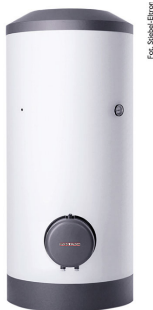
Fot. 3. Stojące pojemnościowe ogrzewacze wody z serii SHW, wyposażone są w zbiorniki o pojemnościach 200, 300 i 400 litrów. Ogrzewacz wykonany jest ze stali. Dodatkowo uwzględniono emalię od środka, która zabezpiecza przed korozją. Oprócz tego zbiornik wyposażony jest w anody ochronne. Przewidziano także bezstopniowy regulator temperatury w połączeniu z ogranicznikiem bezpieczeństwa, który zapewnia odłączenie kołnierza grzejnego na wszystkich biegunach.
