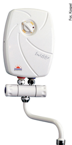
Fot. 1. Przepływowy ogrzewacz wody Twister. Jest to urządzenie bezciśnieniowe, które może współpracować tylko ze specjalną metalową baterią trójdrożną, dołączoną do kompletu. Droбноstrumieniowy perlator zapewnia komfortowe użytkowanie oraz do 50% oszczędności wody i energii. Przełącznik mocy w podgrzewaczu 5,5 kW, umożliwia ograniczenie mocy urządzenia do 4,4 kW.
