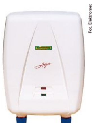
Fot. 2. Przepływowy ogrzewacz wody w wersji AGA jest urządzeniem ciśnieniowym ale może też pracować w układzie bezciśnieniowym, np. z baterią trójdrożną. Przystosowany jest do pracy z większością dostępnych na rynku baterii. Obudowa wykonana jest z tworzywa ABS.
