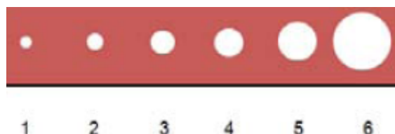
Rys. 3. Wielkość otworów zaworu termostatycznego dla poszczególnych nastaw.
