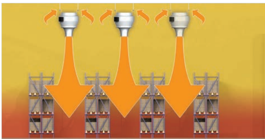
Ujednorodniona dystrybucja powietrza w pomieszczeniu magazynowym wyposażonym w destryfikatory
