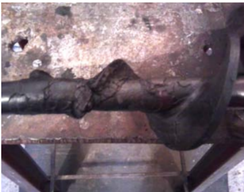
Fot. 2. Uszkodzenie ślimaka w konsekwencji palenia mokrym opałem
