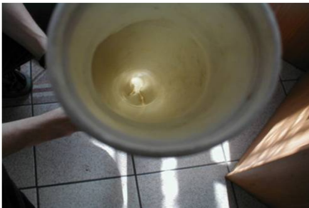
Rys.4 Nieudana próba podgrzania PPS do temperatury 2000C - źródło Kominiarz Polski
