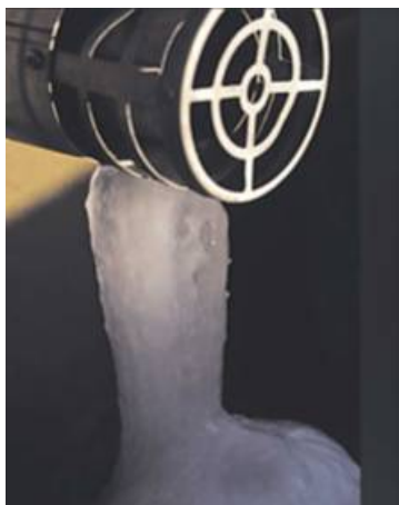
Rys.3 Tworzenie się korków lodowych w warunkach zimowych
