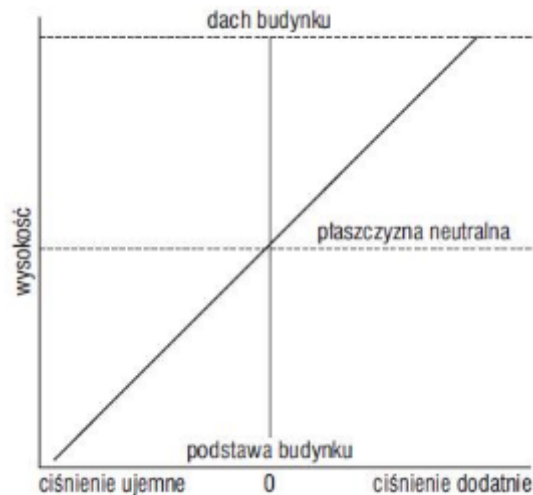
Układ ciśnienia w pomieszczeniu objętym pożarem [1].
